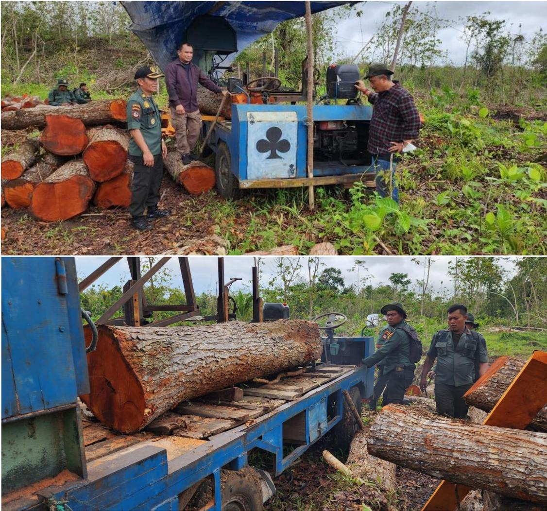
Gambar 8. Alat Pemotong Benso atau Circle untuk mengolah kayu bulat di dalam kawasan hutan Perum Perhutani.
